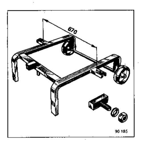
DIAGRAM OF TOOLS TO BE MADE LOCALLY (Dimensions in mm)
