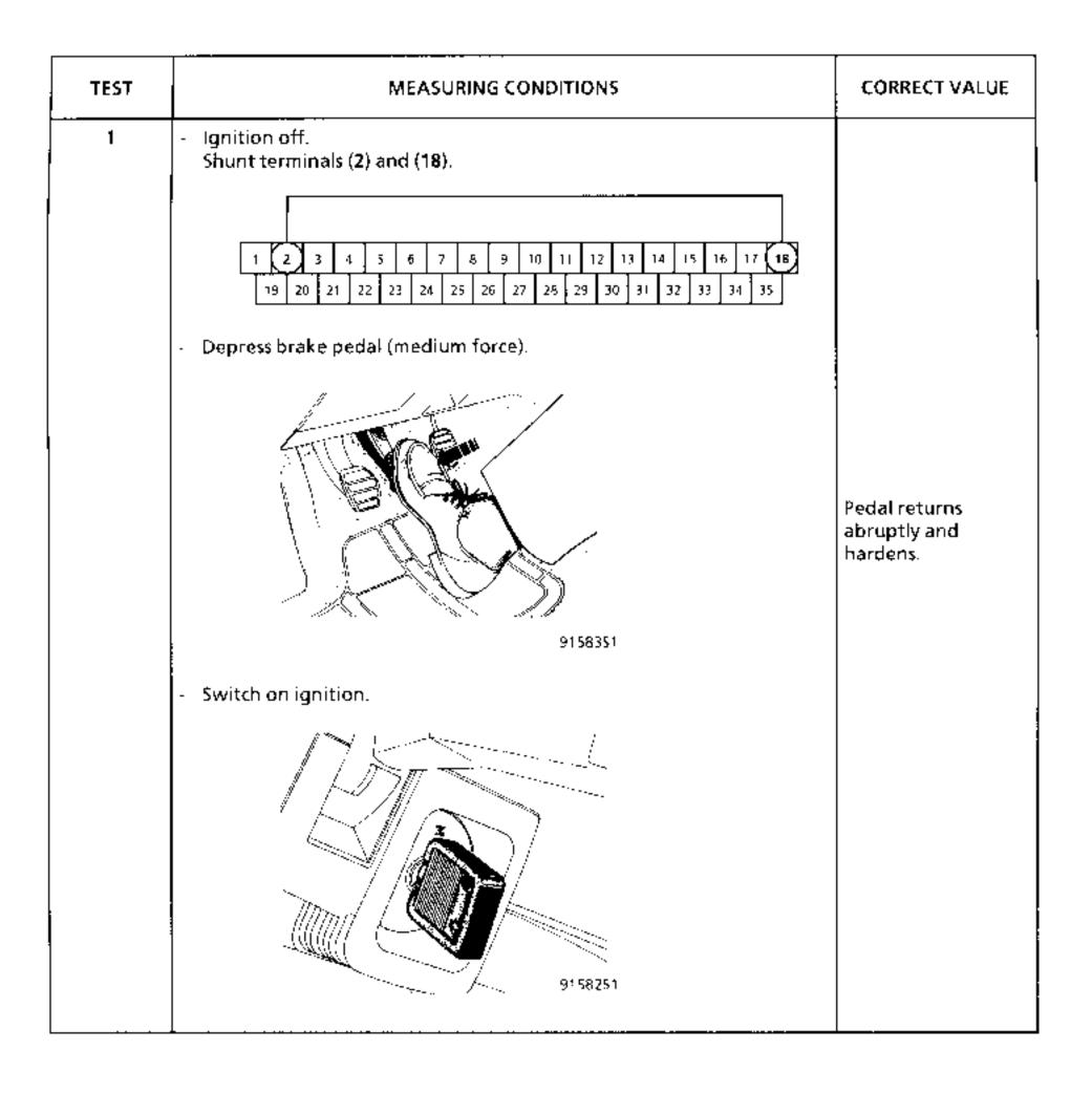
CHECKING THE OPERATION OF THE ROADWHEEL SOLENOID VALVES
