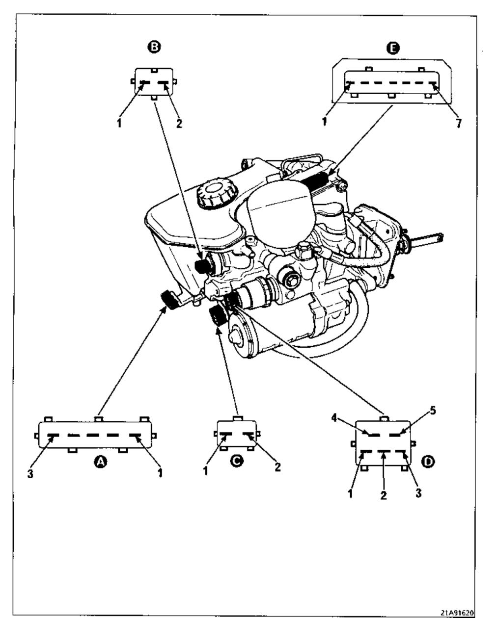
VI - OPERATION OF DOUBLE WARNING DEVICE INCORPORATED IN THE BRAKE FLUID RESERVOIR
