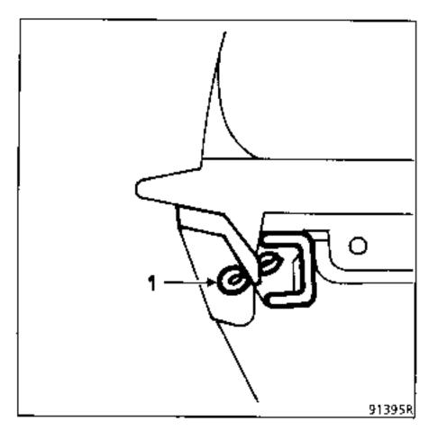
Reconnect the handbrake cables.
